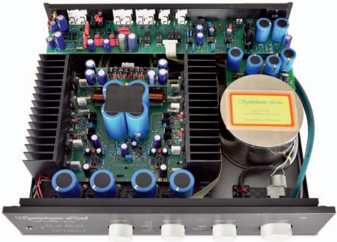
Trafo, der sekundärseitig 400 VA lockermachen kann und dem achtmal 13 000 Mikrofarad Siebkapazität zustehen.
