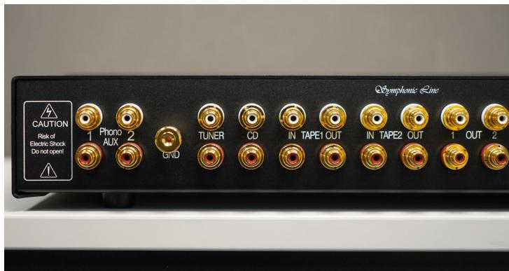
**Reichhaltiges Anschluss-Angebot:** Die RG 3 bietet vier Line-Inputs. Die beiden Aux-Eingänge können alternativ als Phono-Anschlüsse realisiert werden. Dann dient die Ground-Klemme als Massekontakt für den oder die Plattenspieler, um Brummschleifen zu vermeiden. Hinzu kommen gleich zwei Tape-Schleifen für den Anschluss analoger Aufnahmegeräte.
