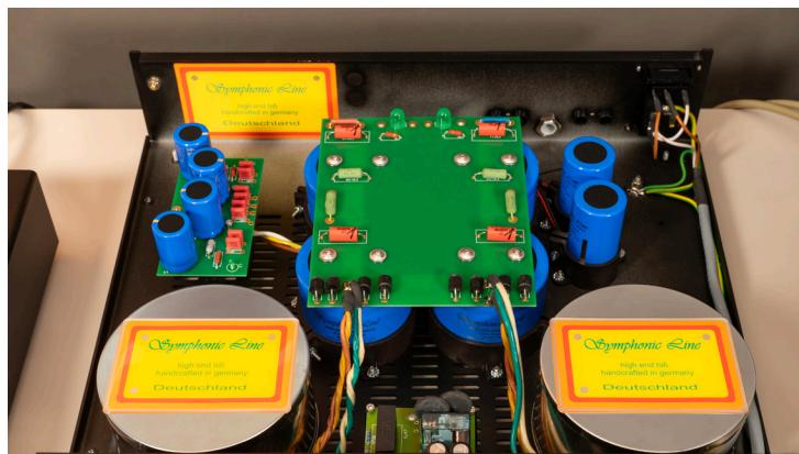
Das Reference Edition-Netzteil ist mit zwei leistungsstarken, 300 Voltampere liefernden MuMetall-Ringkern-Transformatoren ausgestattet. Ebenso großdimensioniert ist die Sektion der Sieb- und Glättungskondensatoren, die eine Gesamtkapazität von 320.000 Mikrofarad bietet. Diese lieferfähige und reservenreiche Stromversorgung ist die Basis für eine ruhige, souveräne Verstärker-Performance - und könnte mit ihrer Potenz eigentlich schon zwei Endverstärker versorgen.
