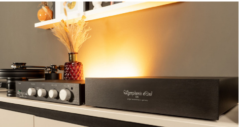
Bei der RG 3 sind Verstärker und Netzteil voneinander getrennt. Dies ermöglicht eine potente Stromversorgung und bewahrt die empfindlichen Audio-Elektronik vor elektromagnetischen Einflüssen der Netzteil-Sektion.
