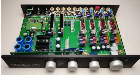
Reichhaltiges Anschluss-Angebot: Die RG 3 bietet vier Line-Inputs. Die beiden Aux-Eingänge können alternativ als Phono-Anschlüsse realisiert werden. Dann dient die Ground-Klemme als Massekontakt für den oder die Plattenspieler, um Brummschleifen zu vermeiden. Hinzu kommen gleich zwei Tape-Schleifen für den Anschluss analoger Aufnahmegeräte. Sämtliche Chinch-Buchsen sind Top-Modelle von WBT.
