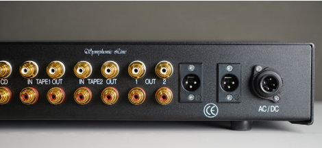
Die RG 3 bietet gleich zwei Ausgänge für den Endstufen-Anschluss. Das ermöglicht einen Bi-Amping-Betrieb mit zwei Endverstärkern. Die beiden XLR-Buchsen können optional als zusätzlicher symmetrischer Eingang oder Ausgang belegt werden. Ganz rechts ist der Anschluss für das externe Netzteil positioniert.
