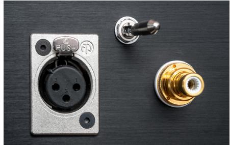
Die Endstufe bietet in der Standard-Ausstattung einen unsymmetrischen Input, der mit erstklassigen Cinch-Buchsen von WBT realisiert ist. Auf Wunsch wird zusätzlich ein symmetrischer XLR-Eingang eingebaut. Zur Umschaltung dient dann ein Kippschalter mit Sicherung: Erst wenn man den Kopf ein wenig herauszieht, lässt sich der Schalter umlegen.
