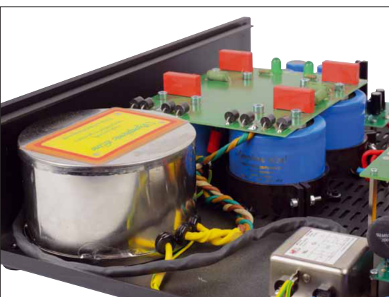
Die speziell für SymphonicLine gefertigten Siebkondensatoren sind nicht weniger beeindruckend als der Trafo
