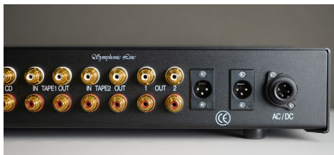
Die RG 3 bietet gleich zwei Ausgänge für den Endstufen-Anschluss. Das ermöglicht einen Bi-Amping-Betrieb mit zwei Endverstärkern. Die beiden XLR-Buchsen können optional als zusätzlicher symmetrischer Eingang oder Ausgang belegt werden. Ganz rechts ist der Anschluss für das externe Netzteil positioniert.
