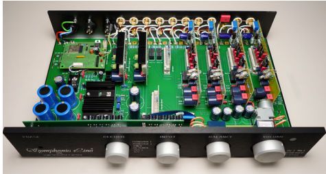
Reichhaltiges Anschluss-Angebot: Die RG 3 bietet vier Line-Inputs. Die beiden Aux-Eingänge können alternativ als Phono-Anschlüsse realisiert werden. Dann dient die Ground-Klemme als Massekontakt für den oder die Plattenspieler, um Brummschleifen zu vermeiden. Hinzu kommen gleich zwei Tape-Schleifen für den Anschluss analoger Aufnahmegeräte. Sämtliche Chinch-Buchsen sind Top-Modelle von WBT.
