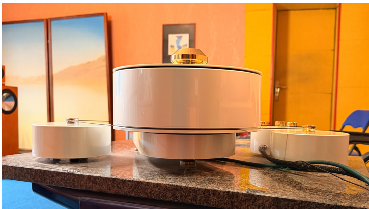
Das Phonokabel wird aus dem Laufwerks-Chassis unterseitig herausgeführt, so lässt es sich optisch unauffällig verlegen. Als Signalkabel kommt hier das Symphonice Line Reference NF-Phonokabel zum Zug.
