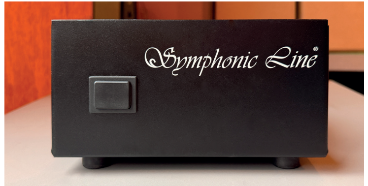
Die Front der externen Stromversorgung. Sie ist im Symphonic Line-typischen robusten Gehäuse untergebracht. Das Netzteil bürgt dank seines potenten Trafos und der satten Kapazität der Siebungs- und Glättungskondensatoren für hohe Lieferfähigkeit und reichlich Reserven. Das befördert die Laufruhe und Stabilität des Antriebs - und damit die gelassene Performance des Laufwerks.
