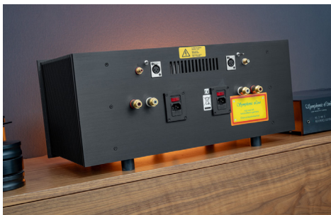
Rückseitig wird der Doppel-Mono-Aufbau der Kraft 300 Class A Anniversary Edition MK 3 ersichtlich: Das Gehäuse beherbergt zwei komplett eigenständige Mono-Blöcke, die konsequenterweise über eine eigene Stromversorgung und dann auch über einen eigenen Netzanschluss betrieben werden. Das gelbe Symphonic Line-Klebe-Pad ist Bestandteil der Klangoptimierung durch Rolf Gemein.
