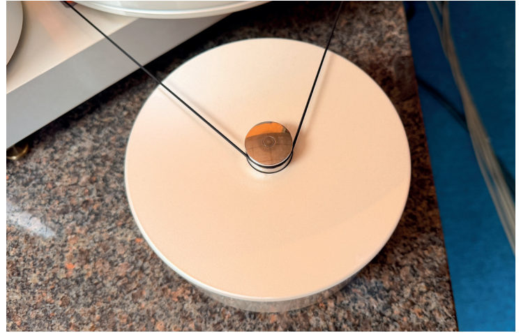
In der Reference-Version ist der RG 6 mit einer zweiten passiven Antriebseinheit ausgestattet. Sie wird gegenüber vom Motor aufgestellt, sodass der Teller des Laufwerks genau dazwischen positioniert ist. Dadurch wird eine einseitige Zugkraft auf die Spindel vermieden - und somit Reibung im Lager minimiert.
