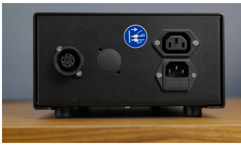
Die Rückseite des externen Netzteils: Der Kaltgeräte-Einbau-Netzstecker rechts unten dient der Verbindung zur Steckdose, über die darüber positionierte Buchse wird die Endstufe des Verstärkers gespeist. Durch die links sichtbare Vierpol-Buchse wird die verstärkerinterne Stromversorgung für die Vorstufe ans Netz gebracht.
