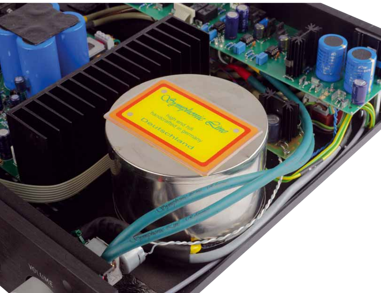
Auch das Kabel vom Lautstärksteller ist nicht zufällig gewählt. Der Aufkleber auf dem Netztrafo ist gelgefüllt
