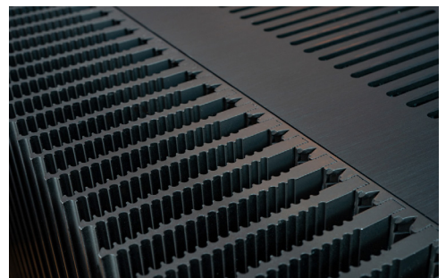
Die seitlichen Kühlrippen-Körper sorgen für eine schnelle Wärmeabfuhr. Dies ist gerade für einen Class A-Verstärker, der prinzipbedingt eine erhöhte Temperatur hat, unabdingbar. Hier setzt Symphonic Line auf teure Rippen-Kühlkörper mit erstklassigem Kühlwert.
