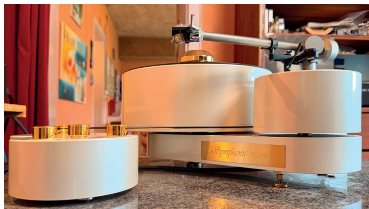
Aus dem Vollen gefräst: Die Komponenten des Masselaufwerks bestehen durch und durch aus Aluminium und sorgen für ein Gesamtgewicht von 50 Kilo. Unter dem Chassis sind die beiden höhenverstellbaren Spikes erkennbar – und, genau unter der Tellermitte, der Fuß, über den die Ableitung der Schwingungsenergie an die Granitplatte stattfindet.
