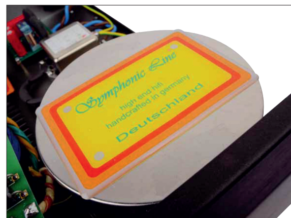
Der weit überdimensionierte Trafo sitzt in einem Mu-Metall-Gehäuse und wird zusätzlich mit einem Gelpad bedämpft
