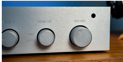
Ja, es gibt sie noch: Die Tape-Schleife ermöglicht bei der Integration eines Tapedecks oder einer Tonbandmaschine eine Hinterband-Kontrolle.
