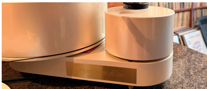
Die Tonarmplattform scheint über dem Chassis zu schweben, hat aber natürlich einen Kontaktpunkt. So ist die Plattform drehbar. Dadurch können verschiedenste Tonarme bis zu einer Länge von zwölf Zoll auf ihr montiert werden.
